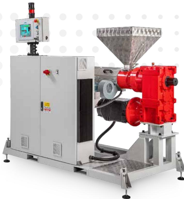
Gli estrusori RSZ prevedono una gamma di macchinari con diametro vite da 45 a 90 mm e L/D 1:25 o L/D 1:30 in funzione della tipologia di materiale.
