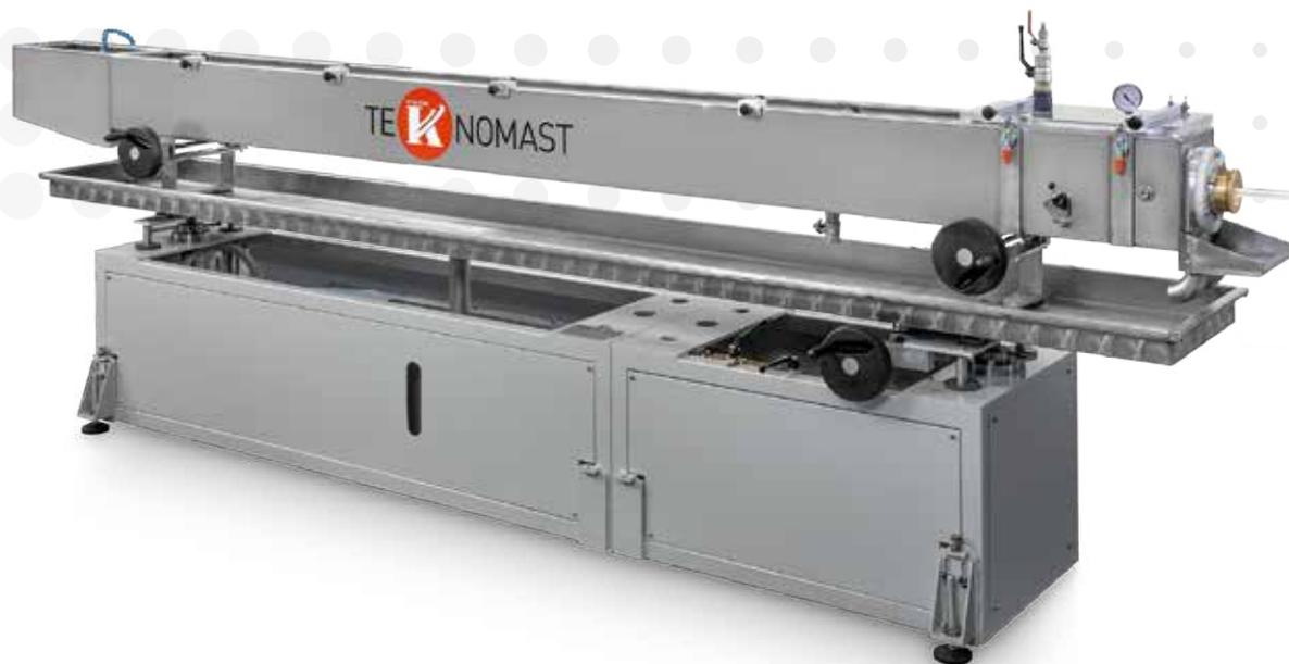
La vasca, modello VRC, è indicata per il raffreddamento e la calibrazione di tubi in HDPE, PP e PVC rigido. Interamente realizzata in acciaio inox, dopo una prima zona di vuoto, all'interno della quale avviene la calibrazione, è dotata di una vasca dove nella prima parte il manufatto è raffreddato per immersione in acqua e nella seconda asciugato tramite un soffio d'aria.
