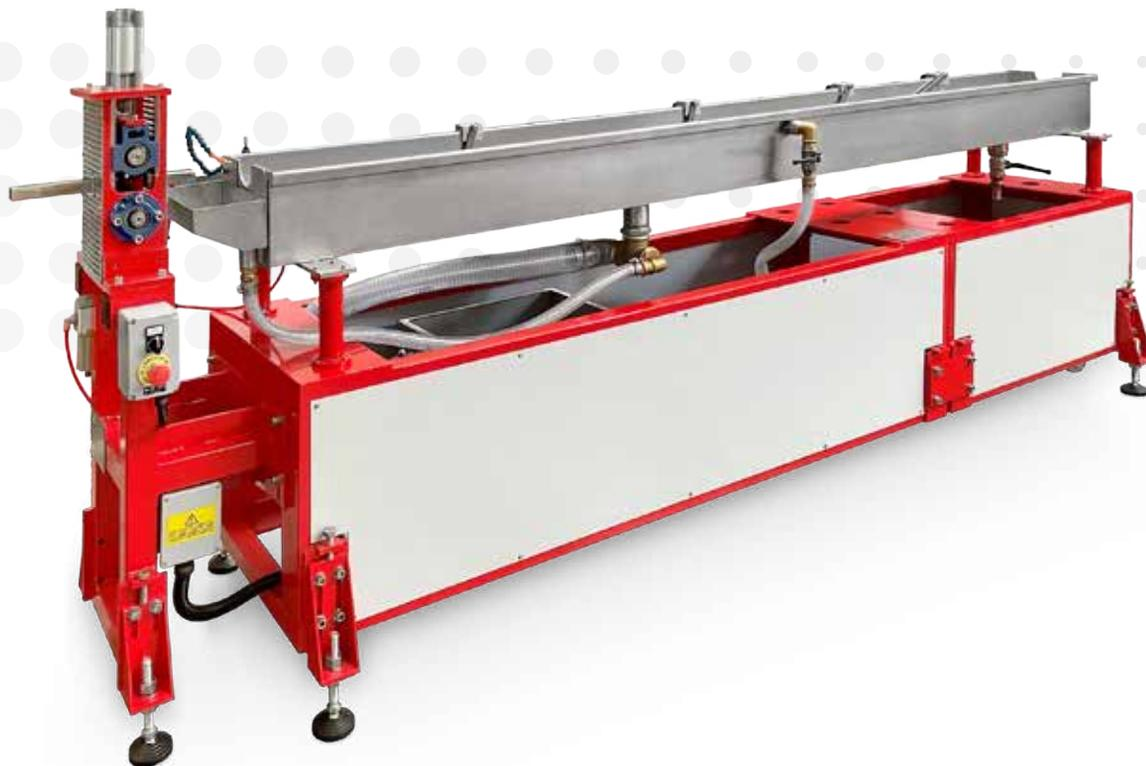
La vasca modello VR è progettata per il raffreddamento di guarnizioni, profili e tubi che non richiedono un sistema di calibrazione a vuoto.
