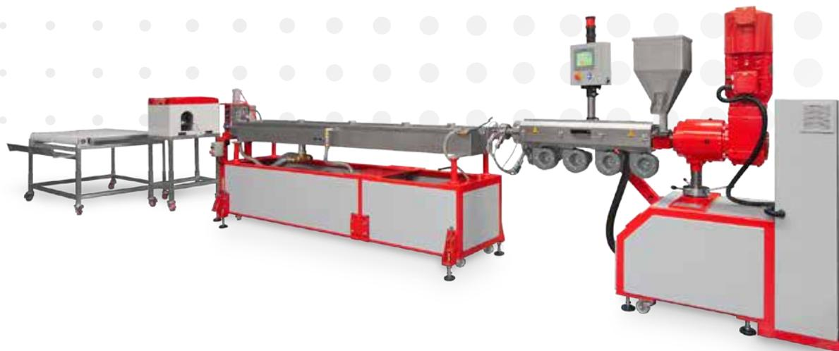
L'attenzione riposta nella definizione dei particolari che compongono la linea, in particolar modo il profilo della vite di plastificazione, la gestione delle temperature, l'individuazione del sistema di raffreddamento, tiro, taglio e raccolta più indicato per una specifica tipologia di profilo, ha fatto sì che le linee di estrusione TeKnomast si distinguano per affidabilità e prestazione.
